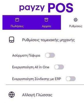
3. Στην συνέχεια πρέπει να ενεργοποιηθεί η Ασύρματη Γέφυρα. Μόλις ενεργοποιηθεί η ασύρματη γέφυρα, θα εμφανιστεί το μήνυμα που φαίνεται παρακάτω στην εικόνα.
